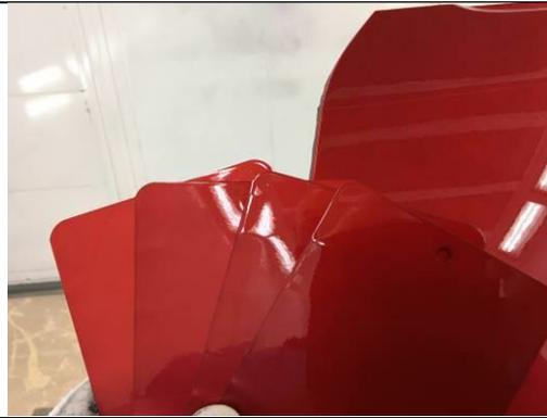
Contrôler les plaquettes d'essai proches de la réparation et déterminer le nombre de couches de finition nécessaires pour reproduire la teinte constructeur.
