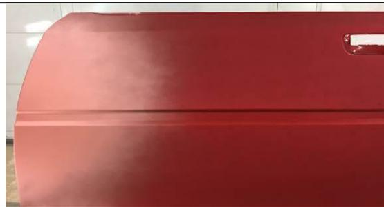
Appliquer la couche de fond conformément à la fiche technique, en respectant les temps d'évaporation entre les couches.
